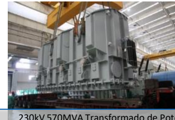
230kV 570MVA Transformado de Potencia Puerto Rico
