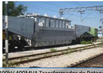
400kV 400MVA Transformador de Potencia Serbia
